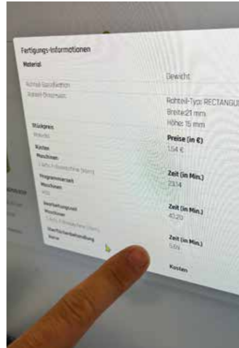
Hertenberger Solutions kalkuliert mittlerweile sehr genau die Rüst- und Spindellaufzeiten für die Serien- und Prototypenteile seiner Kunden – mit immer mehr realen Prozess- und Maschinendaten, die vom Shopfloor direkt in das ERP-System gespielt werden.
