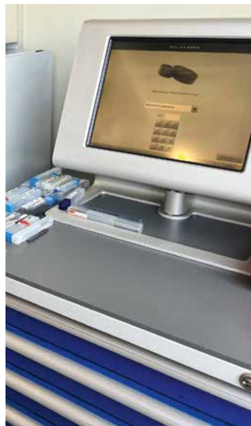
Digitales Toolmanagement: Auch der neu installierte Werkzeugschrank (li.) liefert die nötigen Daten, um die Fertigungsplanung und Arbeitsvorbereitung weiter zu automatisieren.
