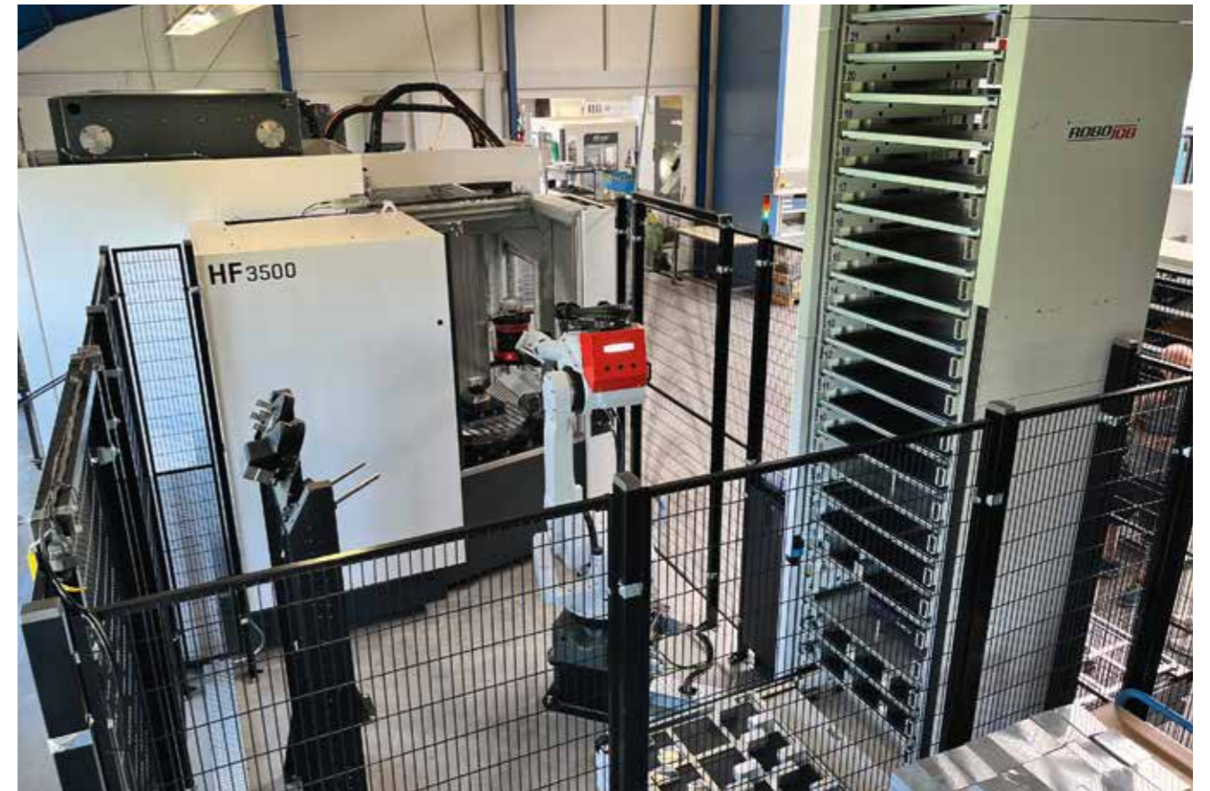
Wie schnell und flexibel die Heller-Robojob-Produktionszelle ist, demonstriert Hertenberger mit der Fertigung von kleinen ‚Haltern‘, die aus 90x50x50-mm-Aluminiumquadern mit 11 Werkzeugen in 12 min aus dem Vollen gefräst werden.
